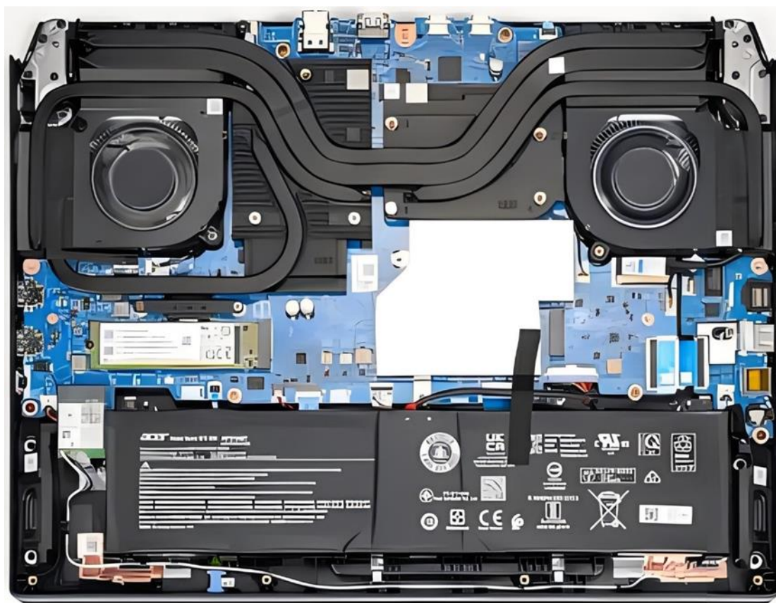
某品牌笔记本电脑五热管双风扇散热系统
